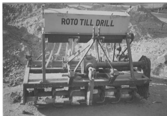
चित्र 5.12 : रोटो टिल ड्रिल – एक अत्याधुनिक कृषि उपकरण
